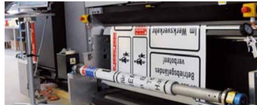
Im digitalen Druckverfahren entsteht auf modernen Maschinen in Beutha Verkehrszeichenfolie in nur einem Arbeitsgang. Die flexible Technik ermöglicht die Herstellung besonders witterungsbeständiger Verkehrszeichen bei wenig Folienabfall und umweltfreundlicher Technologie, da kein Einsatz von Lösungsmittel erfolgt.
