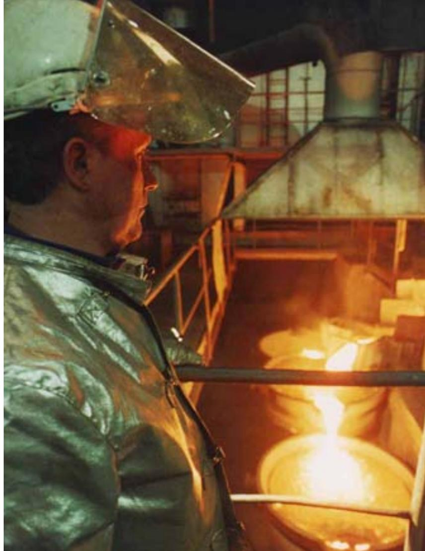
Abstich eines Drehflammofens in der Nickelhütte Aue: Das aus wertmetallhaltigen Abfällen erschmolzene Konzentrat wird in nachfolgenden Prozessschritten zu hochwertigen Nickelsalzen, die beispielsweise in der Galvanotechnik Anwendung finden, weiterverarbeitet.
